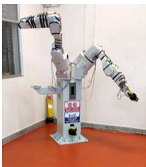
Demonstrační pracoviště se dvěma roboty ABB IRB 1200
